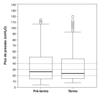
Figura 2 - Distribuição do pico de pressão de ventilação nos pulmões-teste de termo e de pré-termo
